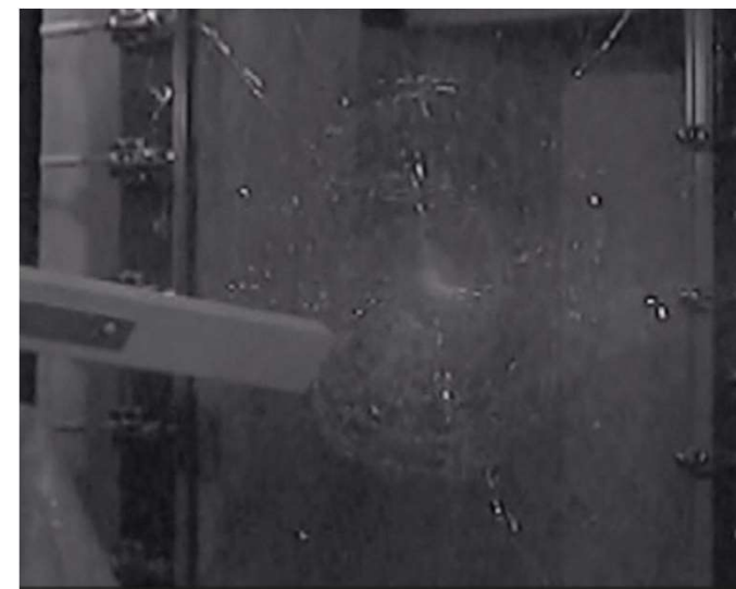
防災安全合わせガラス フロートガラス3ミリ+60ミル※2+3ミリ
