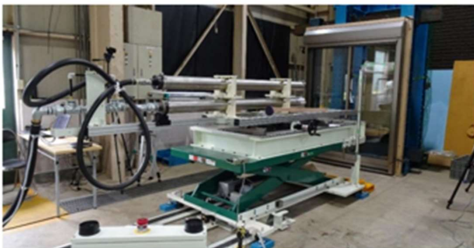
加撃体発射装置（エアキャノン） (一財)ベターリビングつくば試験研究センター
