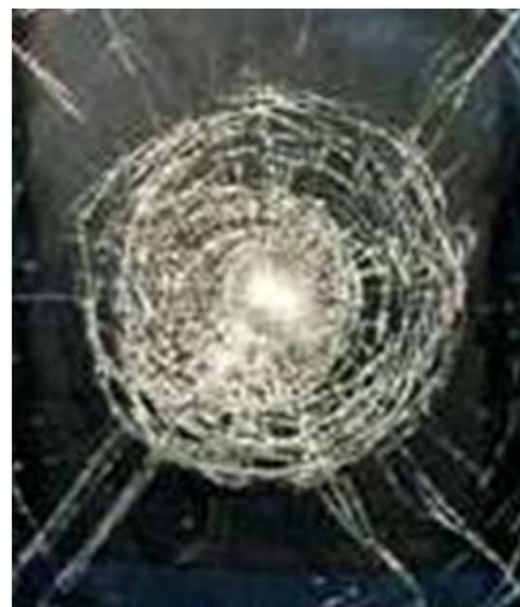
防災安全合わせガラス フロートガラス3ミリ+60ミル※2+3ミリ
