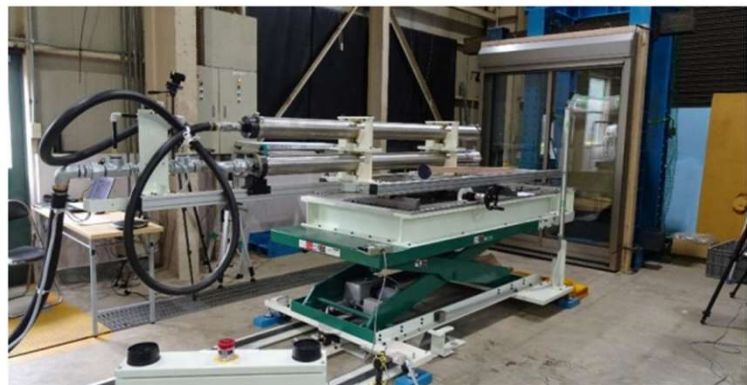
加撃体発射装置（エアキャノン）
